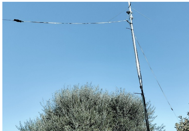
Figure 1. Le dipôle 28 MHz en V inversé.
